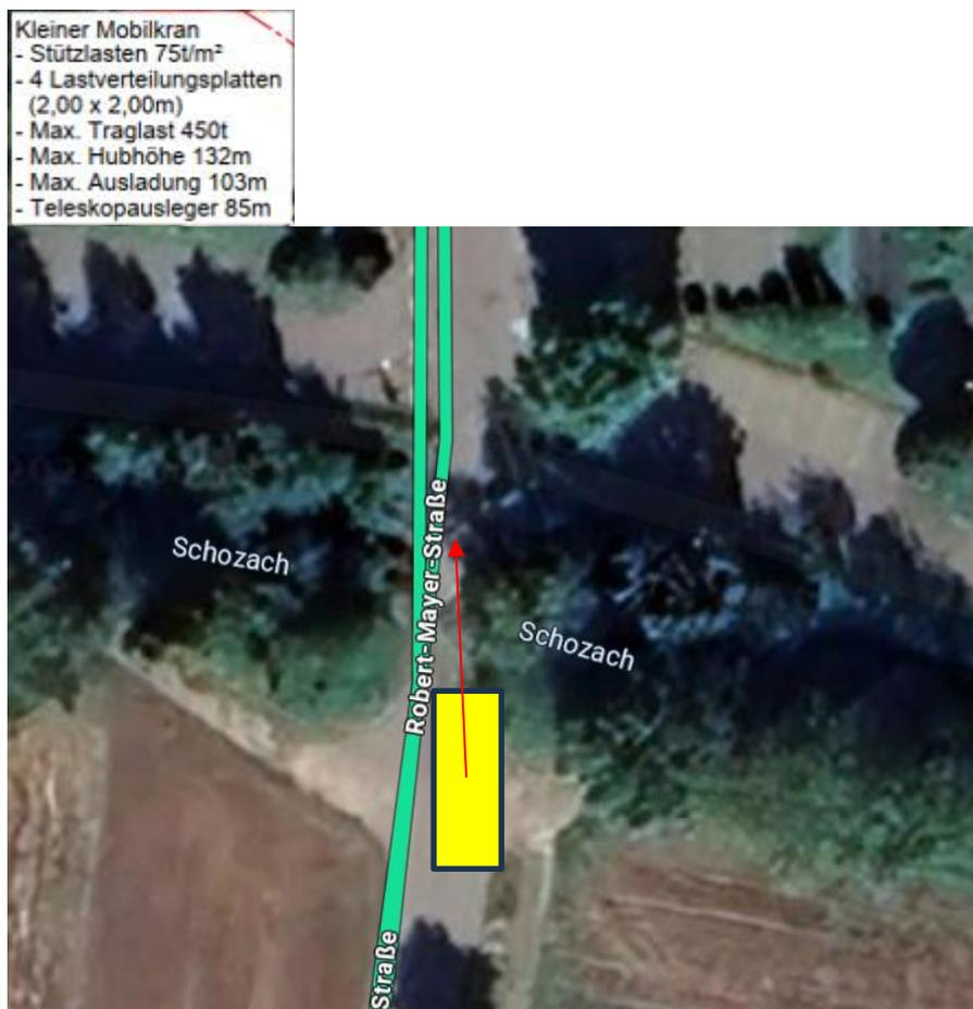
Abb. 18: Standort mobiler Autokran mit Baufeld und Montageplatz südlich der Schozach
